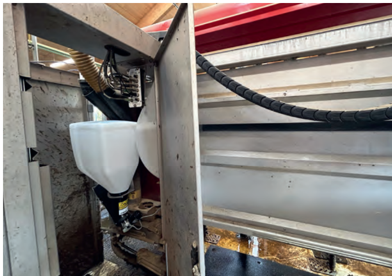
Tildeling av Bovaer® i dispenserløsning i melkerobot. Foto: Ellen Hassel
