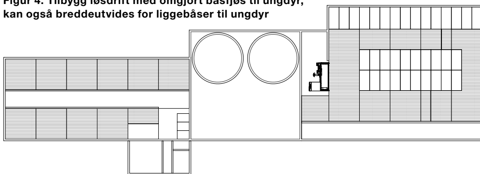
Figur 5. Tilbygg løsdrift i lengderetning av eksisterende førbrett med omgjort båsfjøs til ungdyr, muliggjør gjenbruk av føringslinje
